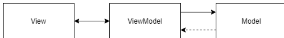
Kuva 5.1: Sovelluksessa käytetty Model-View-ViewModel-arkkitehtuuri.
